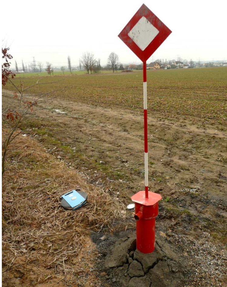
Foto 1: Vystojený vrt IG průzkumu HJ103. Lokalita: vjezdový portál Hosínského tunelu. V pozadí JV část obce Hrdějovice. Situace vrtu - příloha 2.
