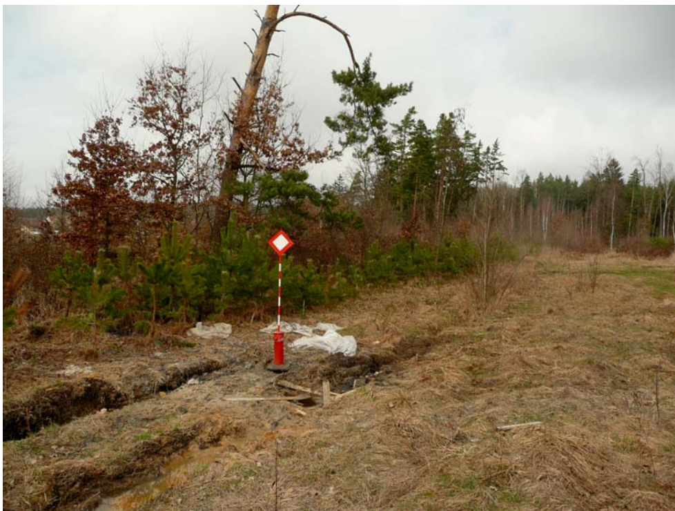
Foto 2: Vystojený vrt IG průzkumu HJ300, na kterém byla provedena čerpací a stoupací zkouška. Lokalita: vjezdový portál Hosínského tunelu. Situace vrtu - příloha 2
